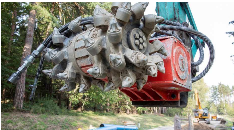
Künettenfräse für Aushub in schwerem Fels
